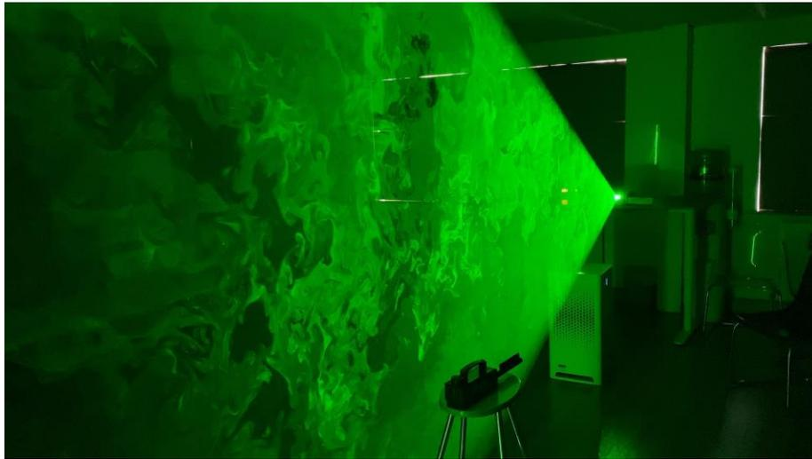
Illustration 5. Photographie montrant le montage utilisé pour les mesures sur le site de Camfil. Observez la feuille laser déployée en vert, le générateur d'aérosol au premier plan et la grande quantité d'aérosol utilisée pour ensemencher l'écoulement. Le City M est observé sous la source laser.
