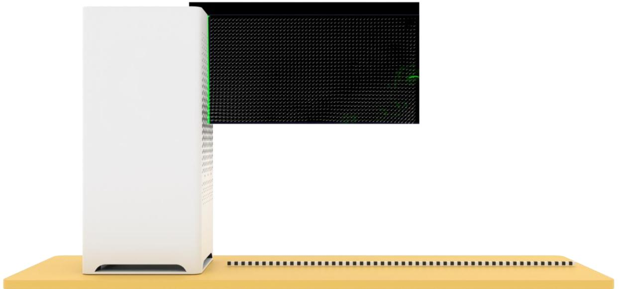
Illustration 7. Mesure PIV pour le flux d'entrée d'air dans le City M avec un générateur d'aérosols placé à 1 m à droite. Le champ de vitesse est superposé à une seule image vidéo. Observez également la barre d'échelle de 1 m.
